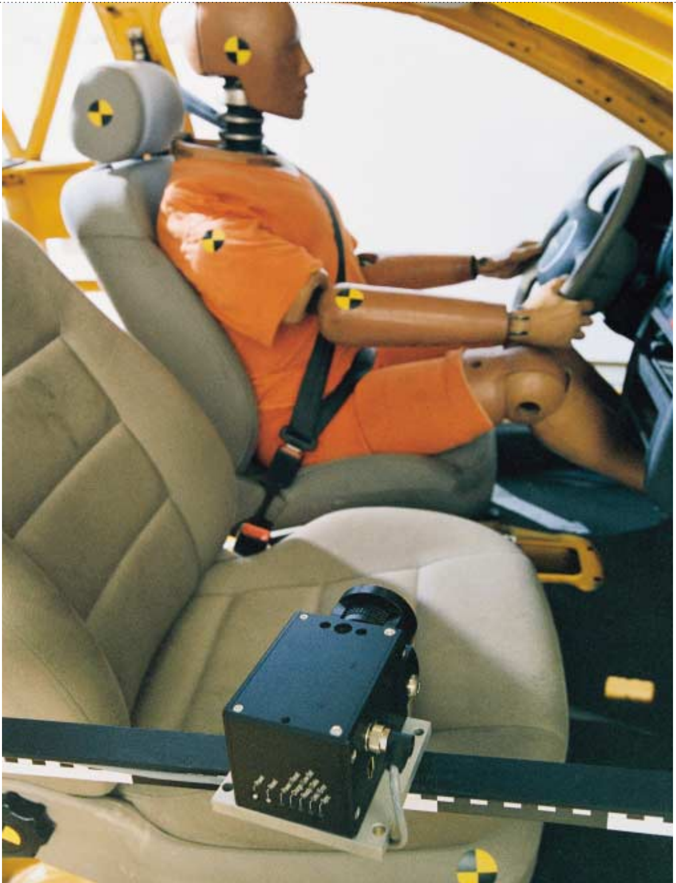
Die sitzt: Die Digitalkamera aus Baden hält – wie hier beim Aufpralltest – die 100fache Erdbeschleunigung in jede Richtung aus und speichert bis zu 32 000 Bilder pro Sekunde
